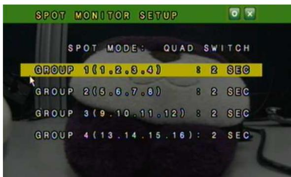
四分割切換(QUAD SWITCH): 透過滑鼠變更頻道切換的秒數。
