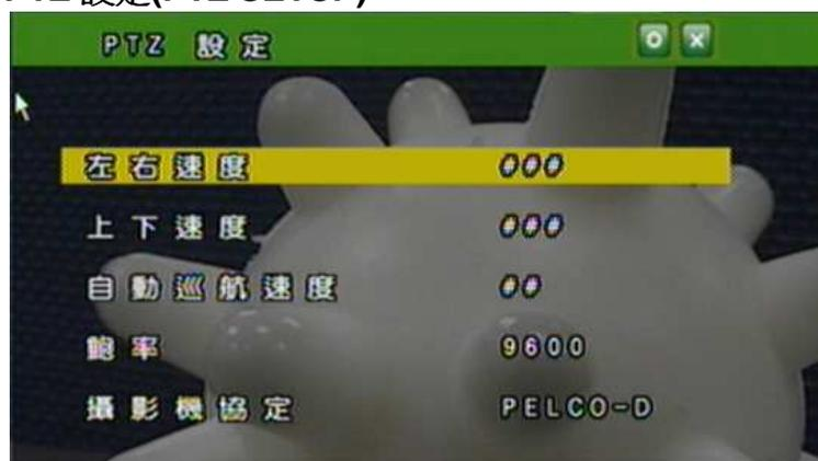
左右速度: 利用滑鼠滾輪調整攝影機左右平擺的速度。
